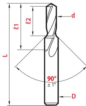
Destinés à usiner en une seule opération le perçage et le chanfreinage avant taraudage. Leur conception assure rigidité et robustesse. La gamme **8254-H** est particulièrement recommandée pour utilisation sur machine CNC. L'âme amincie facilite la pénétration de ces forets (M3 ~ M12).
