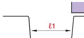
Il convient à l'utilisateur de choisir la largeur  $\ell_1$  adaptée au montage souhaité pour le circlip.
