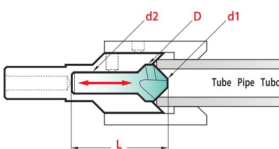
Utilisation simultanée des deux fraises, pour l'ébavurage inter-extérieur de tubes.
